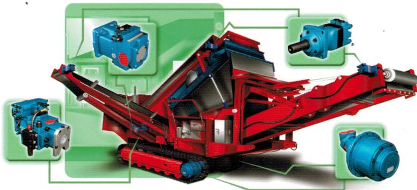
Планетарные редукторы серии S – это оптимальное предложение для любого применения, требующего высокий крутящий момент и минимальные габаритные размеры, как на стационарном промышленном оборудовании, так и для самоходных машин. Эта разработка предпочтительнее традиционных редукторов, так как более компактна и имеет меньший вес по сравнению с традиционными цилиндрическими редукторами. Основные характеристики этой линейки продуктов Brevini:
