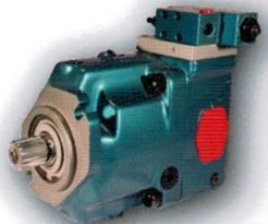
Регулируемый аксиально-поршневой насос (S5AV) для работы в открытом контуре. SAM Hydraulik SH5V предлагается с 6 подачами: от 32 см<sup>3</sup> до 90 см<sup>3</sup>. Максимальное давление до 420 бар. Основные характеристики: прекрасное соотношение мощности и веса, большой выбор устройств управления посредством опций приводного вала, способность устанавливать предел максимальных и минимальных настроек подачи.
